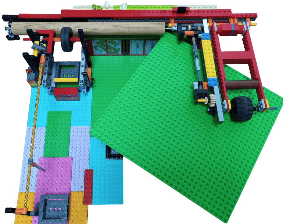
Exemple d'intégrateur mécanique en LEGO remplaçant un ALI intégrateur
